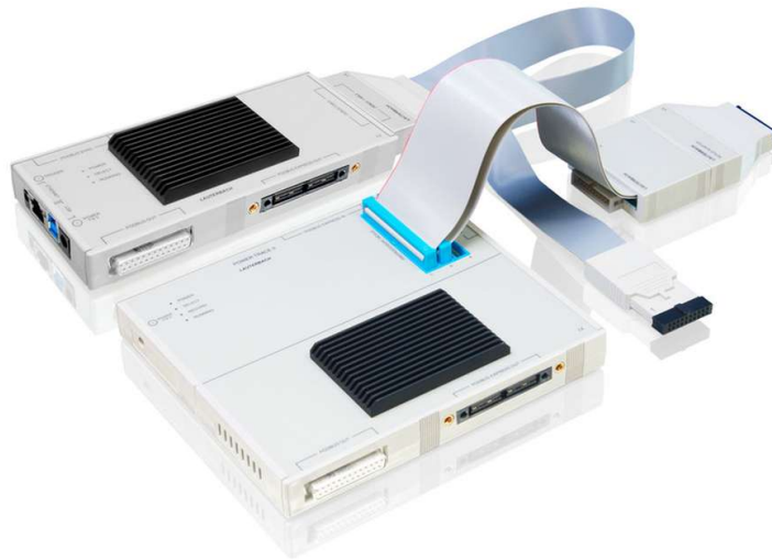
Abbildung 10.1.: Lauterbach Trace Debugger PowerTrace-II
